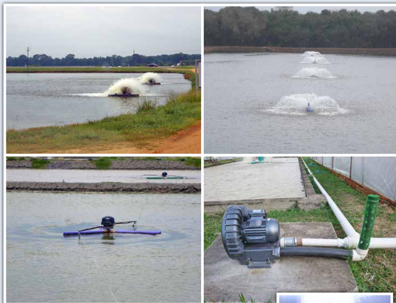
Figuras 4. Diversos tipos de aeradores usados na aquicultura: a) aeradores de pás; b) aerador do tipo fonte ou bomba vertical; c) aerador em sistema venturi; c) soprador de ar e, d) difusor de membrana
