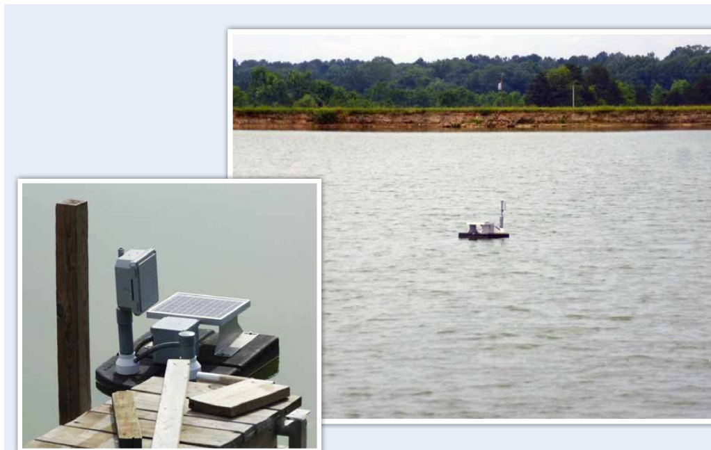
Figura 2. Sensores de oxigênio em tempo real que comandam o acionamento dos aeradores remotamente
