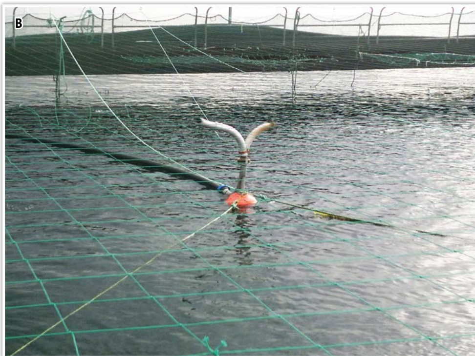
Figuras 1. A , mangueiras pressurizadas distribuem ração de silos até as gaiolas de cultivo. B , dispensadores de ração funcionam múltiplas vezes ao dia, mantendo peixes jovens saciados ao longo de todo dia
