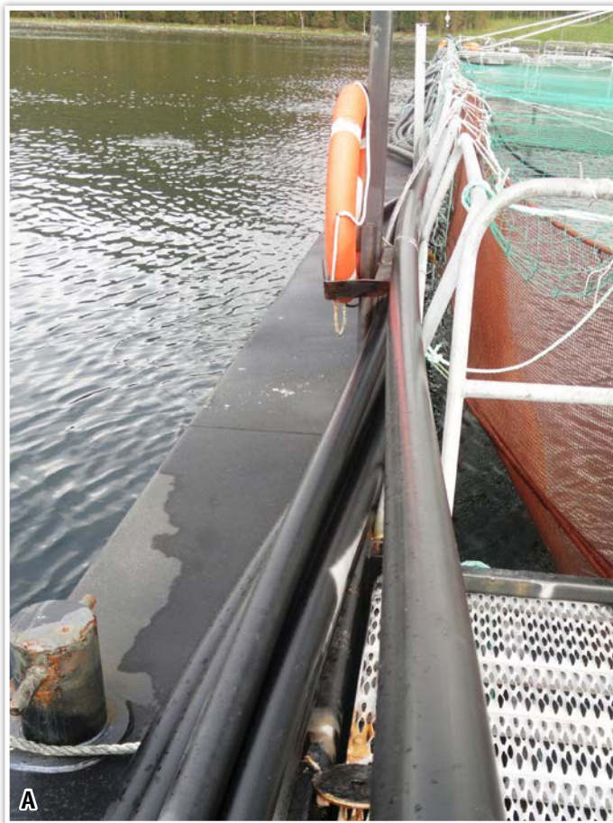
Figuras 1. A , mangueiras pressurizadas distribuem ração de silos até as gaiolas de cultivo. B , dispensadores de ração funcionam múltiplas vezes ao dia, mantendo peixes jovens saciados ao longo de todo dia
