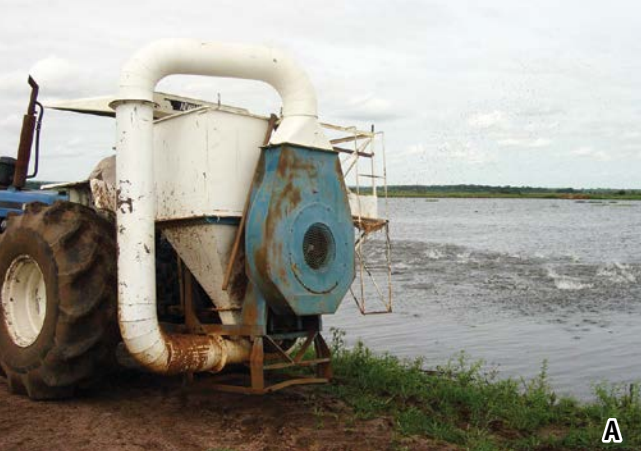
Figuras 6. A, Sopradores utilizados para alimentação de peixes cultivados em viveiros em Mato Grosso e B, em gaiolas em Pernambuco
