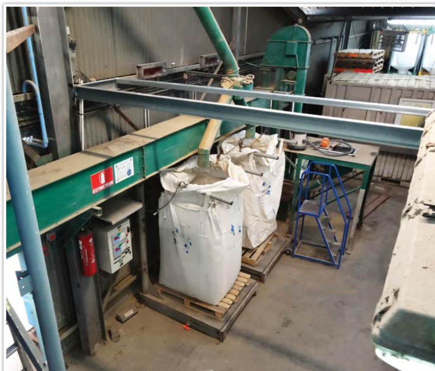
Figura 3. Unidade fabril para rações de camarões adaptada para ensaque em big bags
