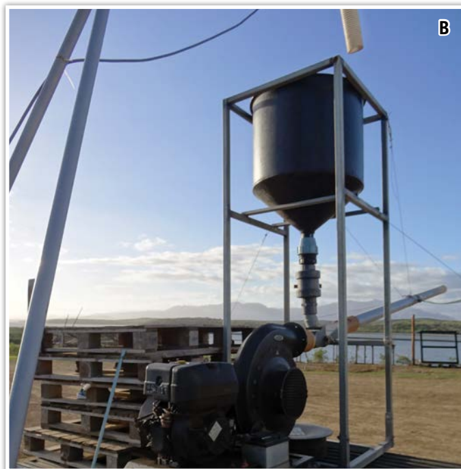
Figuras 4. A, silo utilizado para armazenamento de ração em uma fazenda de camarão e posterior transferência para caminhão adaptado com soprador. B, o soprador movido com motor a combustão pode lançar a ração de 15 a 20 m de distância do talude
