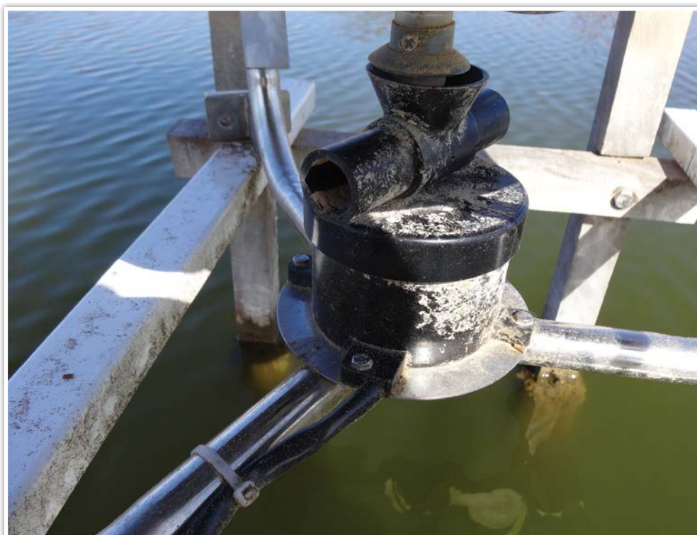
Figura 10 B , lançador em plástico com motor em sua base para girar quando acionado
