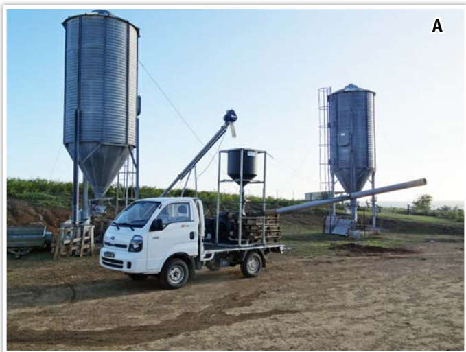
Figuras 4. A, silo utilizado para armazenamento de ração em uma fazenda de camarão e posterior transferência para caminhão adaptado com soprador. B, o soprador movido com motor a combustão pode lançar a ração de 15 a 20 m de distância do talude
