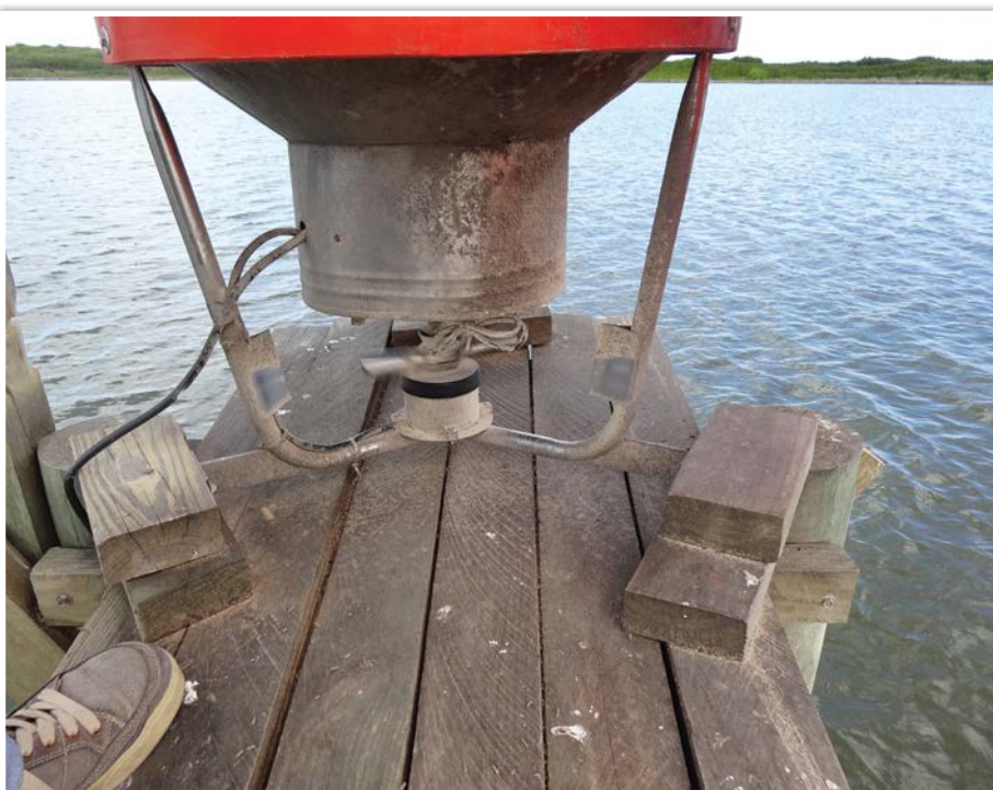
Figura 10 A , vista da base de um dispensador automático de ração, corpo inferior feito em aço-inox
