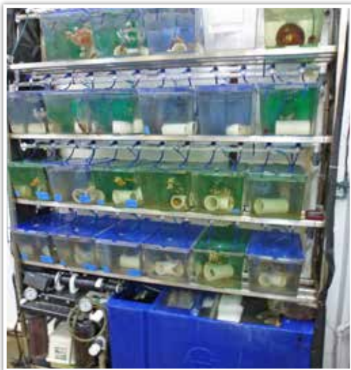
Pequeno sistema de recirculação para manutenção e reprodução de peixes marinhos
